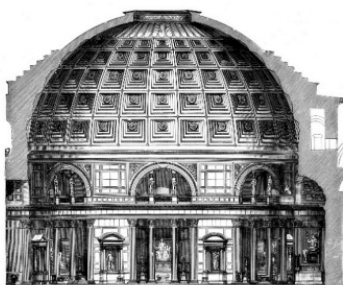
Panteon, przekrój przez budowlę
